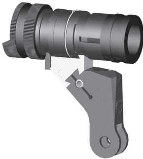
Bild 17: Universalkornträger zu Stgw 57 (Normalmontage), diverse Fabrikate
